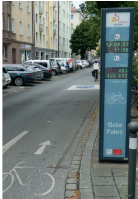
Display für Zählstelle an der Humboldtstraße in Höhe des Kopernikusplatzes; auf der Fahrbahn in der Mitte Induktionsschleifen für die Zählung (Foto: H. Roß)
