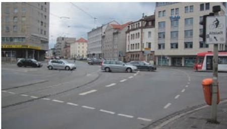
Die Kreuzung am nördlichen Ausgang des Marientunnels ist für Radfahrer völlig unübersichtlich und wegen des starken Autoverkehrs in beiden Richtungen sehr gefährlich. Der Radweg aus dem Tunnel endet ohne Ausleitung auf die Fahrbahn.
